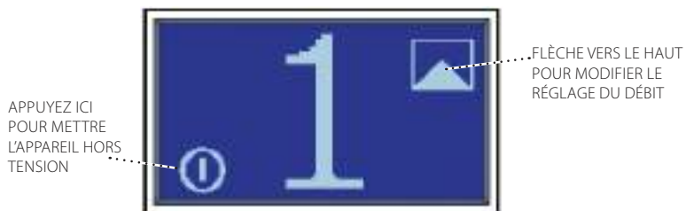
Figure 16. Pour modifier le réglage du débit, appuyez sur la valeur du réglage (Il s'agit ici du chiffre 1). Ceci provoque l'apparition d'une flèche de modification du débit vers le haut. Pour augmenter le réglage du débit, appuyez sur la flèche vers le haut jusqu'à atteindre la valeur prescrite. La flèche de réglage du débit disparaît 5 secondes après son activation. Pour un autre exemple sur les flèches de modification du débit, reportez-vous à la figure suivante.
