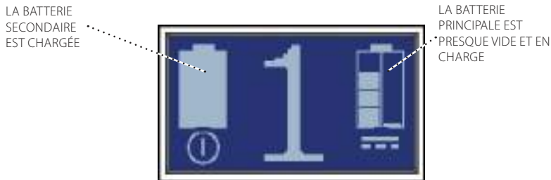
Figure 15. Cet affichage montre que les deux batteries sont insérées. Il montre aussi que l'appareil est connecté à une source d'alimentation. La batterie secondaire (à gauche) est complètement chargée. La batterie principale (à droite) est presque vide et en cours de charge.
