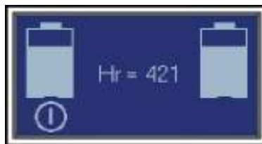
Figure 8. Appuyez sur le symbole Marche/Arrêt pour démarrer. Le nombre à l'écran (par exemple H = 421) présente le nombre d'heures de fonctionnement de l'appareil.
