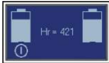
Figure 5. Écran normal de démarrage présentant les deux batteries, chacune chargée à 75 % et avec une utilisation de l'appareil de 421 heures.
