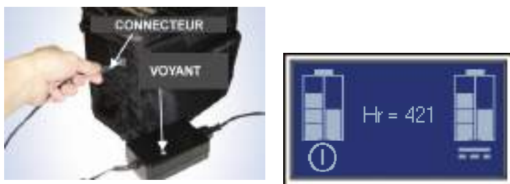
Figure 6. Branchement du cordon d'alimentation sur le connecteur sous le rabat avec velcro. Un écran normal de charge de la batterie est présenté à droite
