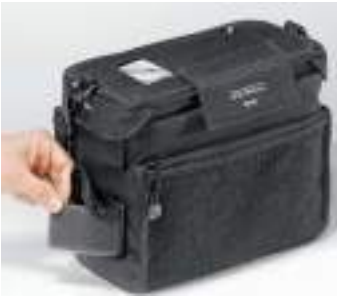
Figure 21. Dépose du filtre d'entrée d'air pour nettoyage.
