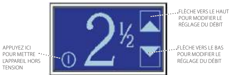
Figure 17. Pour modifier le réglage du débit, appuyez sur le nombre du réglage ; ici, il s'agit de 21/2. Ceci provoque l'apparition des flèches vers le haut et vers le bas. Pour augmenter le réglage du débit, appuyez sur la flèche vers le haut à droite jusqu'à atteindre la valeur prescrite. Pour diminuer le réglage du débit, appuyez sur la flèche vers le bas. Les flèches de réglage du débit disparaissent en appuyant à nouveau sur le nombre ou 5 secondes après avoir touché l'écran pour la dernière fois.
